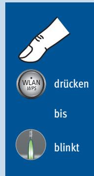
Die WLAN-Verbindung wird hergestellt.
