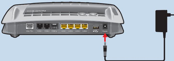
3. Stecken Sie das Netzteil in eine Steckdose.
